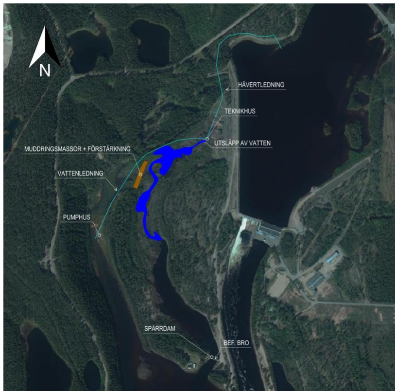
Figur 16, med markering var vattenledning, pumphus, teknikhus, hävertledning och spärrdam och förstärkningsåtgärder ska anläggas samt var muddringsmassor ska avläggas som en del av förstärkningsåtgärderna.
